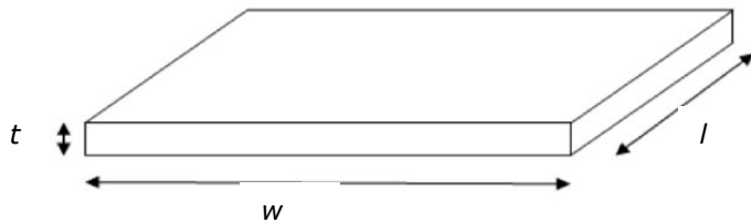
Gambar 3. Resistansi logam dalam bentuk tiga dimensi.
