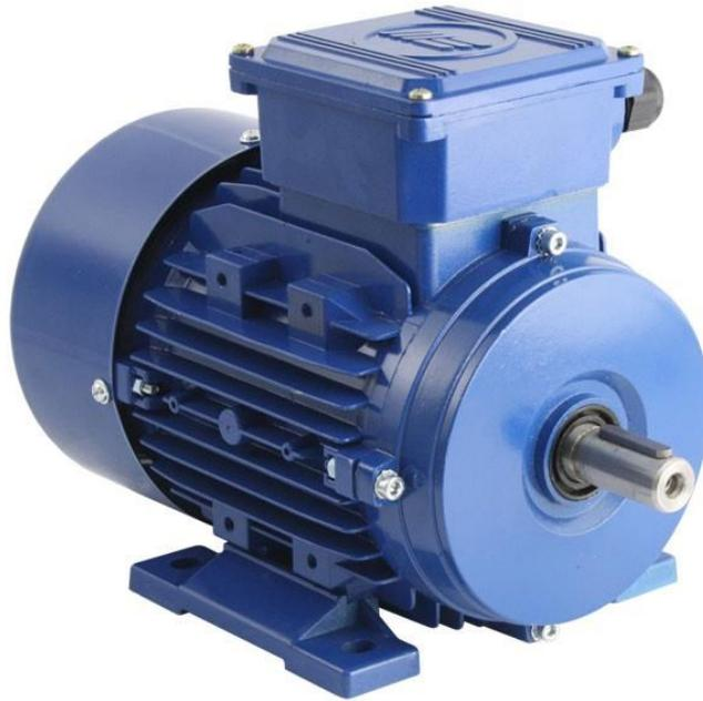
**Plat 1.1** Motor induksi sangkar berventilasi kipas tertutup total (TEFV). Contoh khusus ini memiliki rating 200 W (0,27 HP) pada 1450 RPM, dan berada di ujung bawah rentang daya untuk versi 3 fasa. Casing terbuat dari aluminium cor, dengan udara pendingin disediakan oleh kipas yang tertutup di ujung bagian non-drive.
