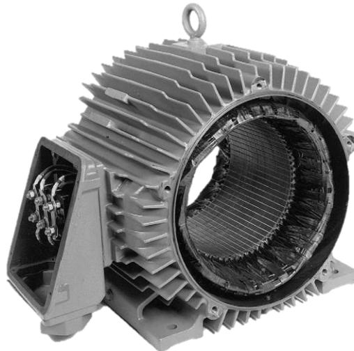
Gambar 1.1 Stator dari motor induksi tiga fasa. Slot semi tertutup dari inti stator mengaburkan sisi aktif dari gulungan stator, tetapi ujung gulungan hanya terlihat di bawah pita pengikat. (Foto oleh Brook
