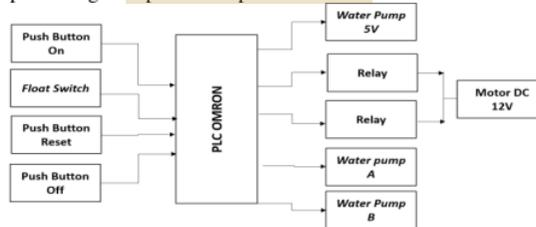
Gambar 1. Diagram Blok Rancangan Sistem
