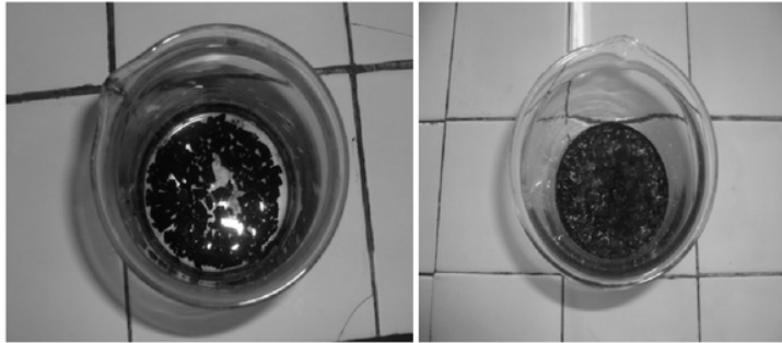
Gambar 1. Perendaman dengan ZnCl 2 dan CaCl 2 25%
