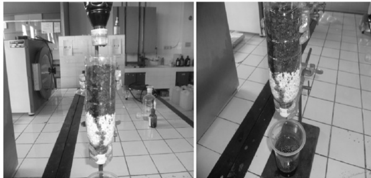
Gambar 5. Penjernihan Asap Cair dengan Kolom Arang Aktif
