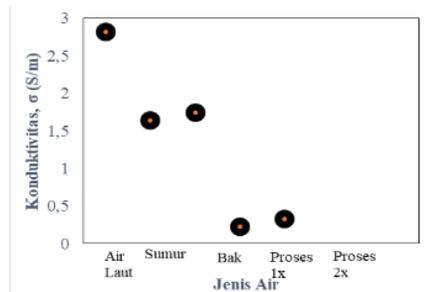
Gambar 3. Grafik hubungan jenis air, dengan konduktivitas,  $\sigma$  ( $\Omega.m$ )<sup>-1</sup>
