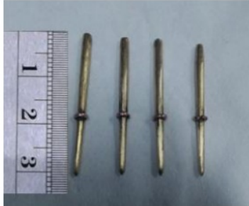
Gambar 1. Probe 4 titik sebelum dideposisi dengan Ag.
