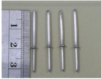
Gambar 8. Foto kaki probe setelah dideposisi dengan Ag.
