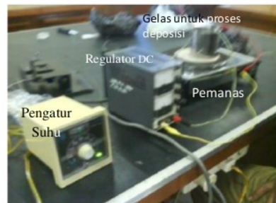
Gambar 2. Rangkaian alat pada proses electroplating
