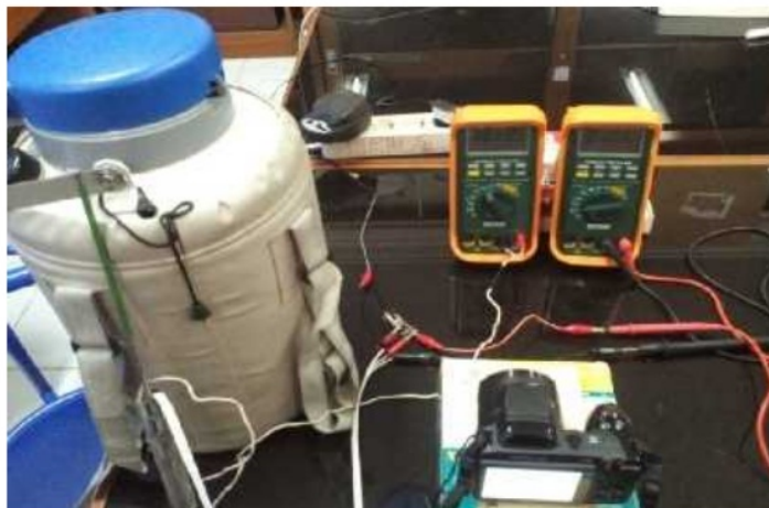
Gambar 3. Rangkaian alat pada saat pengambilan data pengukuran suhu rendah.
