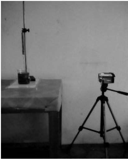
Gambar 2. Foto rangkaian alat penentuan nomor orde penampang geometri benda
