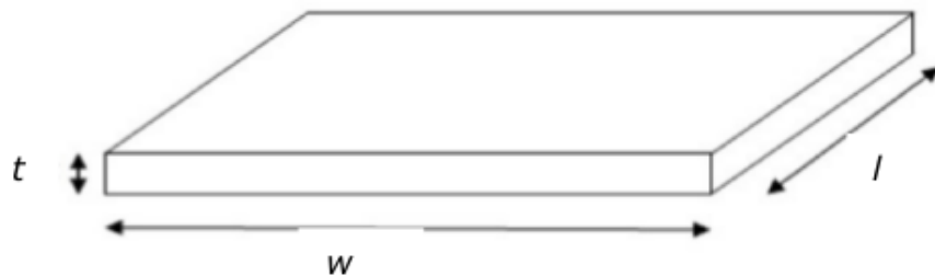
Gambar 3. Resistansi logam dalam bentuk tiga dimensi.
