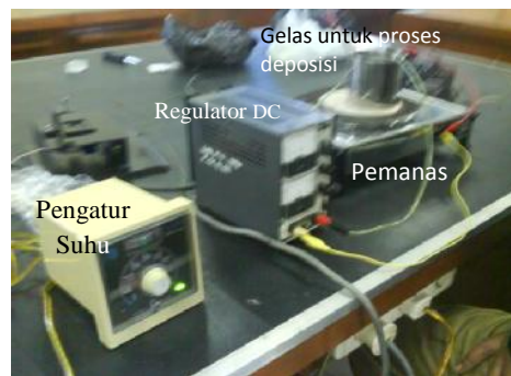
Gambar 2. Rangkaian alat pada proses electroplating
