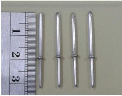
Gambar 8. Foto kaki probe setelah dideposisi dengan Ag.
