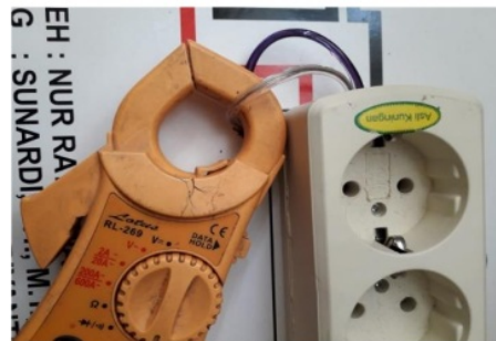
Gambar 6. kabel yang dibelah untuk mengukur arus dengan clampmeter
