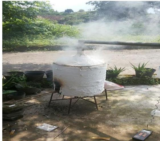
**Gambar 1.** Pembuatan arang dengan metode pirolisis.
