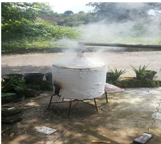
Gambar 1. Pembuatan arang dengan metode pirolisis.
