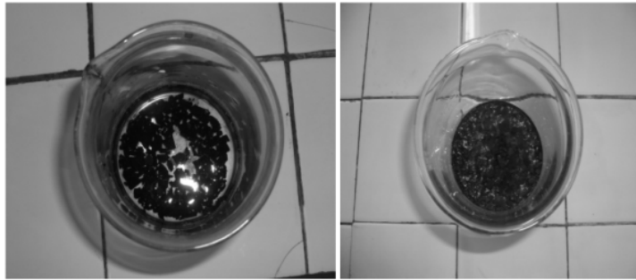
Gambar 1. Perendaman dengan ZnCl 2 dan CaCl 2 25%
