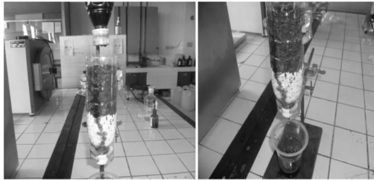
Gambar 5. Penjernihan Asap Cair dengan Kolom Arang Aktif
