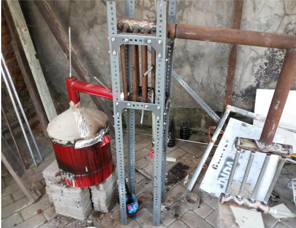
Gambar 4. Prototipe alat pengembun uap cair
