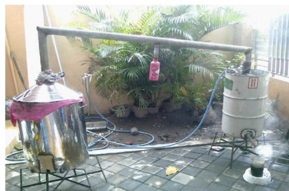
Gambar 1. Alat penghasil asap cair tanpa redistilasi
