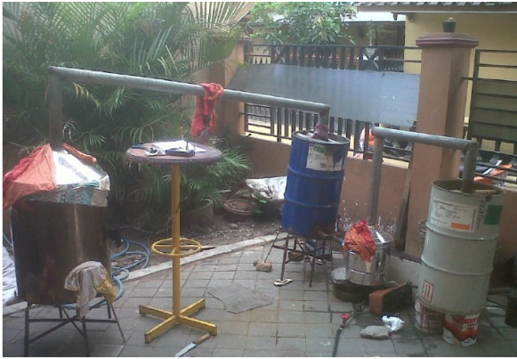
Gambar 2 . Unit alat penghasil asap cair dengan redistilasi
