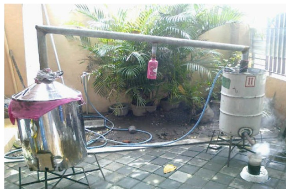
Gambar 1. Alat penghasil asap cair tanpa redistilasi
