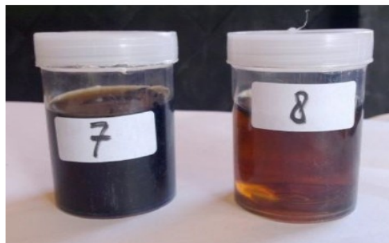
Gambar 2. Asap cair yang dihasilkan dengan redistilasi di tangki Redistilasi( 7) dan hasil dari kondensor 2(8)
