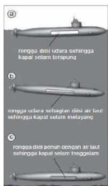
Gambar 8.18. Proses mengapung, melayang, dan tenggelam kapal selam.
