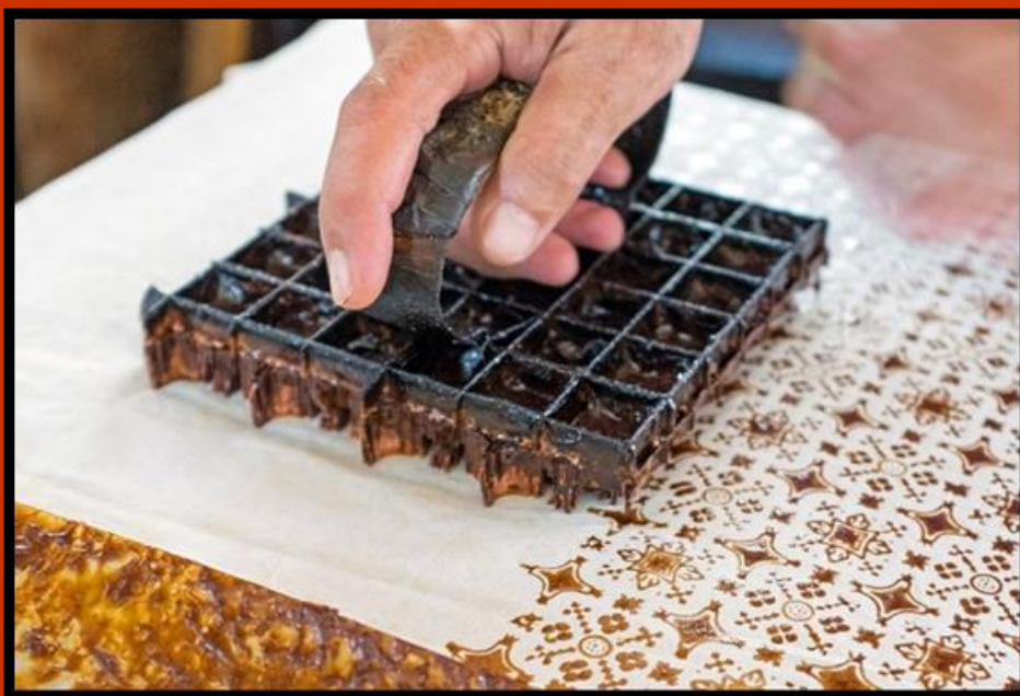
Gambar 34. Alat Cap Batik dari Logam Sumber: https://bit.ly/3jtpiEU
