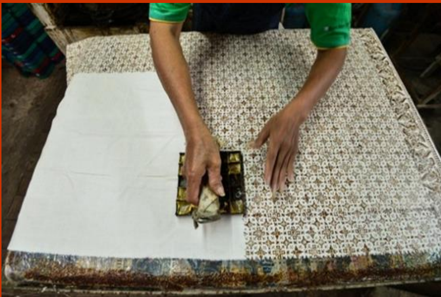
Gambar 9. Teknik Batik Cap Sumber : www.quoracd.net
