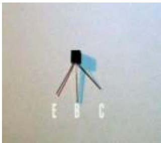
Gambar 4. Bentuk kumparan transmitter dengan “centre tap” (kiri), bagian dari transistor (kanan) (sumber: instructables.com)
