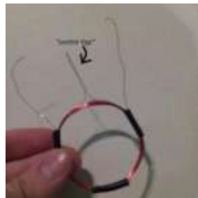
Gambar 4. Bentuk kumparan transmitter dengan “centre tap” (kiri), bagian dari transistor (kanan) (sumber: instructables.com)
