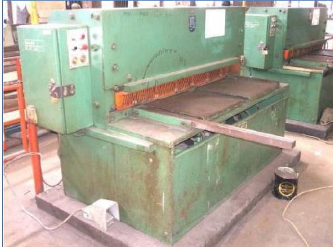
Gambar 15. Mesin guillotine otomatis
