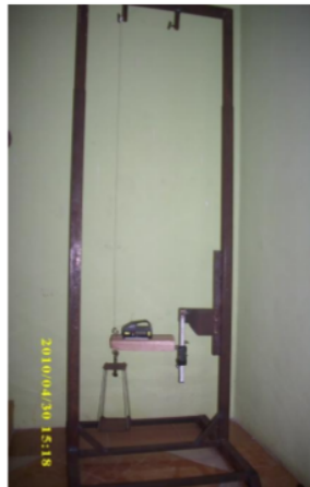
Gambar 2. Alat percobaan untuk menentukan modulus Young.
