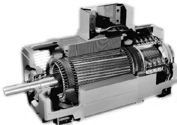
Plate 1 Gambaran dari motor dc 4-kutub yang dibelah. Belitan jangkar miring pada rotor terhubung di ujung kanan melalui riser ke segmen komutator. Ada empat set sikat, dan masing-masing lengan sikat
