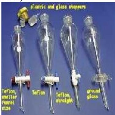
Berupa corong yang bagian atasnya bulat dengan lubang pengisi terletak di sebelah atas, bagian bawahnya berkatup. Terbuat dari kaca.
