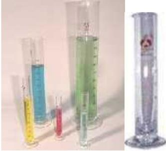
Digunakan untuk mengukur volume zat kimia dalam bentuk cair. Alat ini mempunyai skala, tersedia bermacam-macam ukuran., mulai dari 10 mL sampai 2 L. Tidak boleh digunakan untuk mengukur larutan/pelarut dalam kondisi panas. Perhatikan meniscus pada saat pembacaan skala.
