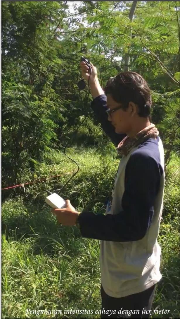
*Pengukuran intensitas cahaya dengan lux meter*
