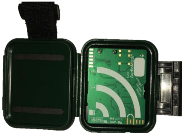
Gambar 24. Audiomoth yang terbungkus cover pelindung
