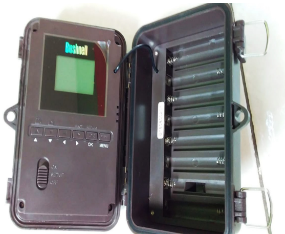
Gambar 21. Bagian dalam kamera traps merk Bushnell yang berisi menu dan tempat peletakkan baterai
