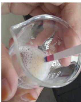
Gambar 20. Proses Uji pH Sabun
