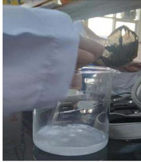
Gambar 13. Proses Pelarutan NaOH Dengan Air
