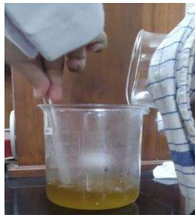
Gambar 14. Proses Pencampuran Minyak Murni Dengan Larutan NaOH
