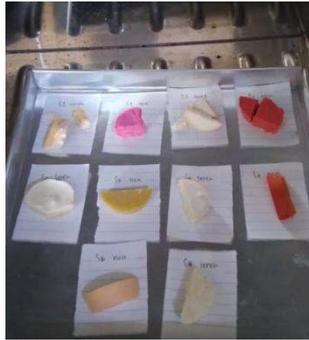
Gambar 19. Proses Pengeringan Sabun Di Dalam Oven
