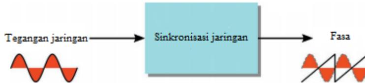
Gambar 7.3. Struktur dasar sistem sinkronisasi jaringan dalam aplikasi yang terhubung dengan jaringan
