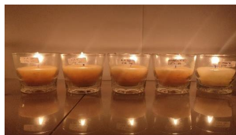
Gambar 7. Lilin dengan 100 gram stearin setelah dibakar
