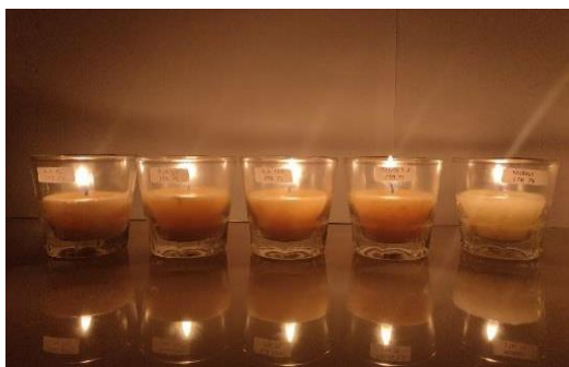
Gambar 5. Lilin dengan 75 gram stearin setelah dibakar
