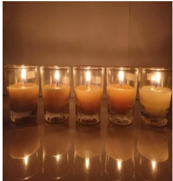
Gambar 3. Lilin dengan 50 gram stearin setelah dibakar
