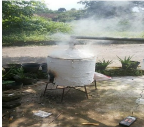
Gambar 1. Pembuatan arang dengan metode pirolisis.
