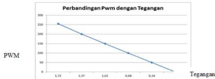
Gambar 7. Perbandingan PWM dengan tegangan output dari arduino
