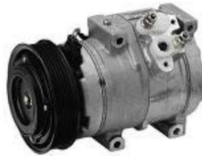
Kompresor berfungsi untuk mengalirkan refrigerant atau freon di dalam sistem AC mobil. Kompresor AC mobil umumnya digerakan oleh mesin mobil itu sendiri. Agar kompresor bisa dihidupkan dan dimatikan sesuai keinginan saat menggunakan AC, maka penghubung putaran ke mesin menggunakan kopling magnet.
