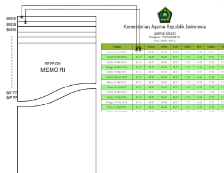
Gambar 2. Peletakan Data Jadwal Sholat Pada Memori Eeprom
