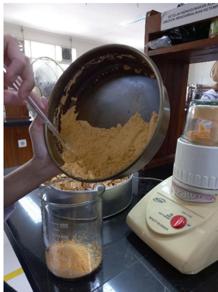
Gambar 10. Proses Pengayakan Chip Menjadi Tepung Menggunakan Saringan 80 Mesh
