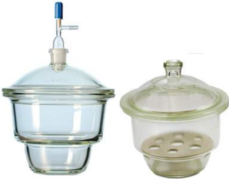
Gambar 3.20. Desikator vakum (kiri) dan desikator biasa (kanan)
