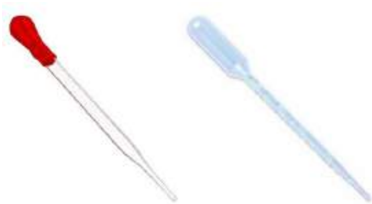
Gambar 3.5 Pipet tetes kaca (kiri) dan pipet tetes plastik (kanan).
