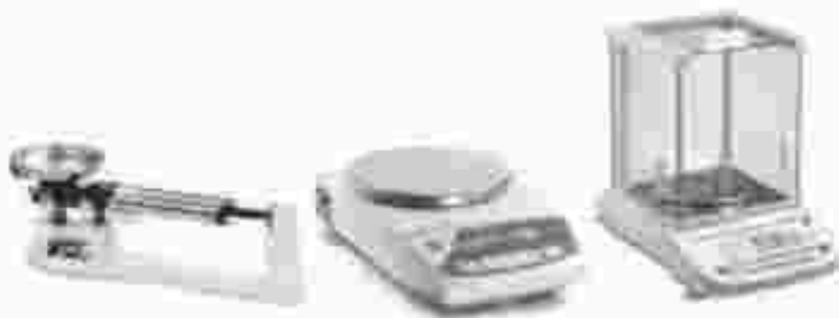
Gambar 3.19. Jenis-jenis timbangan yang biasa digunakan di laboratorium: timbangan triple beam (kiri), timbangan top loading balance (tengah) dan timbangan presisi Mettler (kanan).
