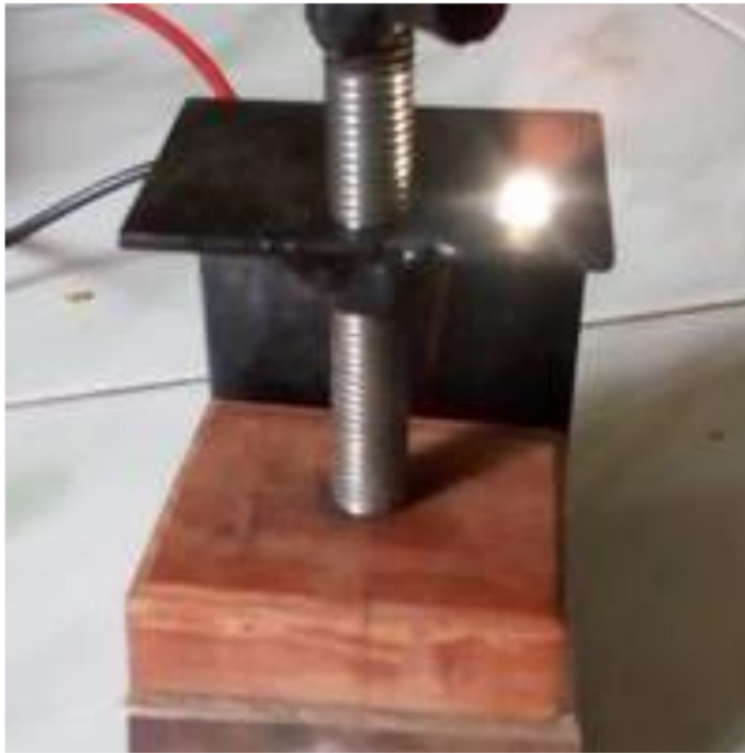
Gambar 3. Desain Awal Alat Tambal Ban Portable
