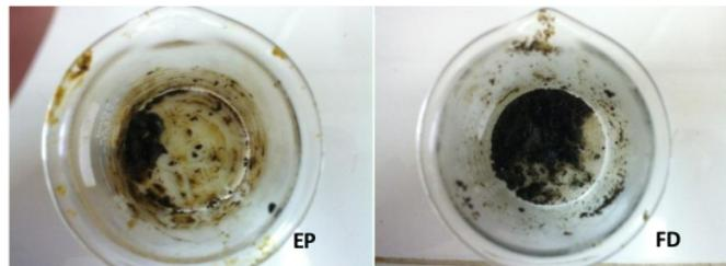
Gambar 1. Ekstrak hasil penguapan dengan *Rotary evaporator* (EP) dan *Freeze Dryer* (FD)
