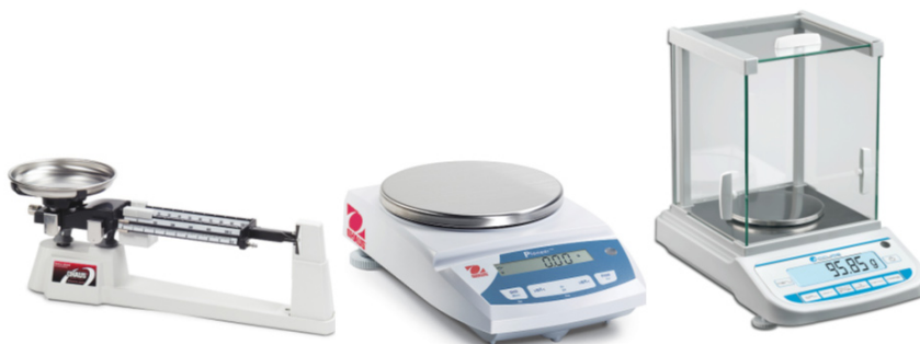
Gambar 3.19. Jenis-jenis timbangan yang biasa digunakan di laboratorium; timbangan triple beam (kiri), timbangan top loading balance (tengah) dan timbangan presisi Mettler (kanan)
