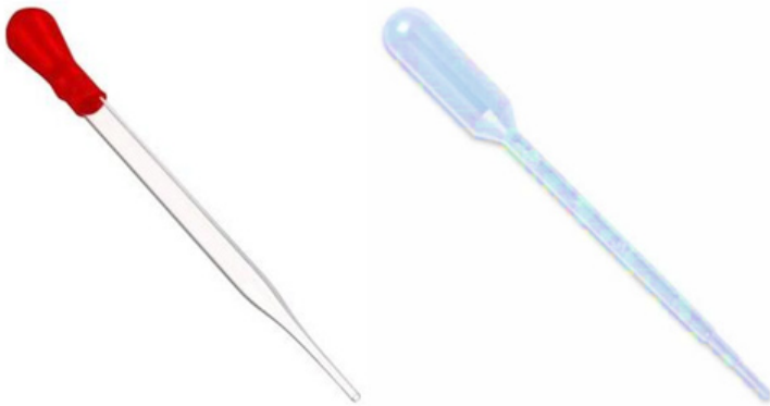
Gambar 3.5 Pipet tetes kaca (kiri) dan pipet tetes plastik (kanan).
