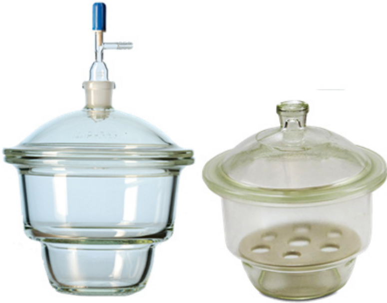
Gambar 3.20. Desikator vakum (kiri) dan desikator biasa (kanan)
