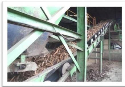
Gambar 1. 12 Singkong masuk ke mesin conveyor
