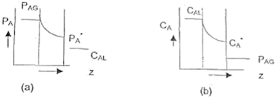
Gambar 10. Ilustrasi Perpindahan Massa (a) Fasa Gas (b) Fasa Cair
