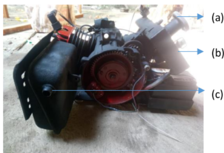
Gambar 2. Mesin 2 tak (penghasil CO 2 ) (a) pengisian bahan bakar (b) starting mesin (c) pipa keluar gas
