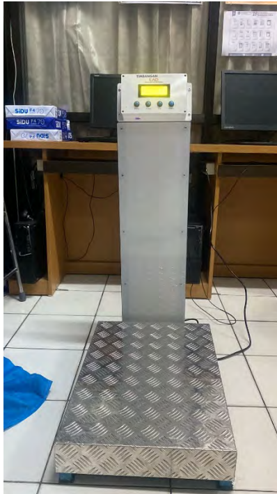
Gambar 1. Timbangan digital yang dibangun dengan teknologi IoT
