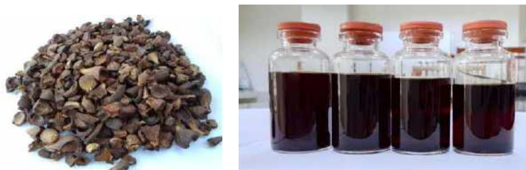
Gambar 1. LPPKS dan bio-oil hasil pirolisis
