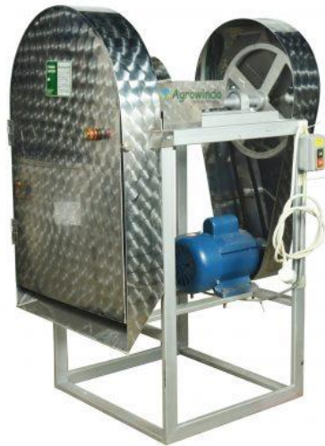
Gambar 1. 10. Alat Perajang/Pengiris Singkong. (Sumber : Maksindo.co, 2021)
