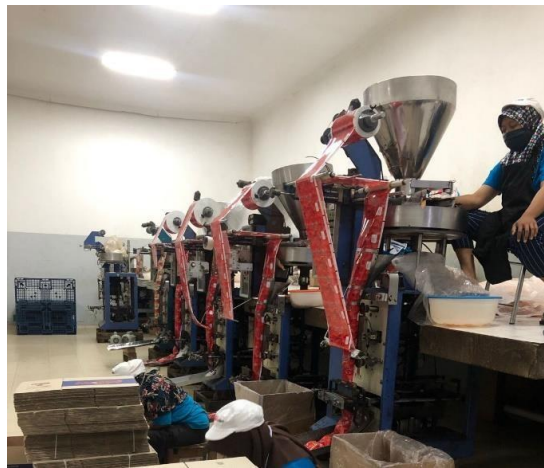
Gambar 1. 28. Mesin Pengemasan Otomatis (Mesin Vertikal Packaging Machine )
