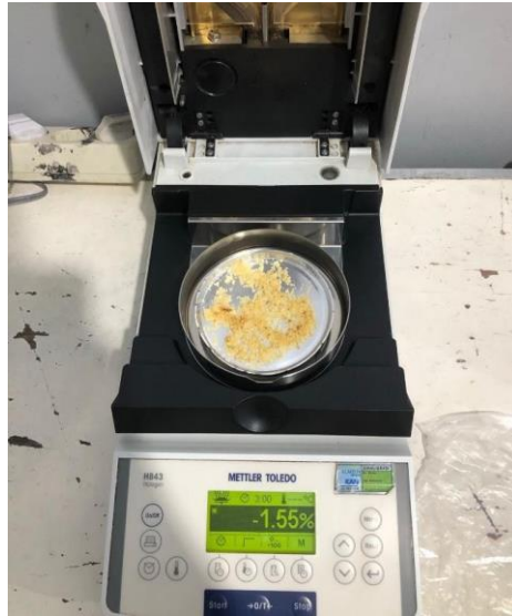
Gambar 1. 29. Alat Penguku Kadar Air. (Sumber : Dokumentasi Pribadi, 2021)
