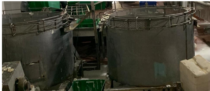
Gambar 1. 24. Alat Pengereng Minyak ( Spinner ).
