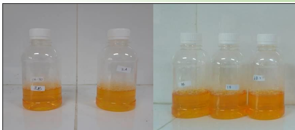
Gambar 3. Pengaruh waktu saponifikasi. (a) saponifikasi 12 jam, (b) saponifikasi 24 jam
