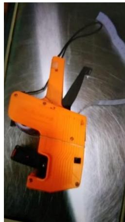
Gambar 1.39. Mesin pencetak tanggal kadaluarsa
