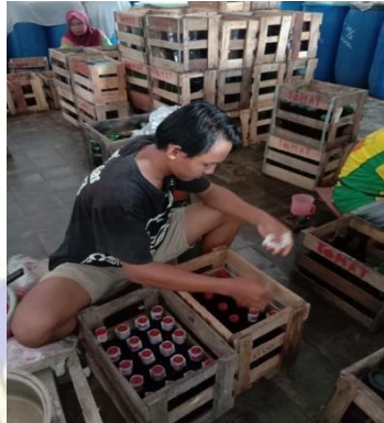
Gambar 1. 24 Proses pengisian kecap ke dalam botol
